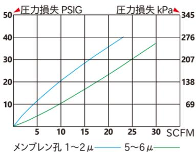
空気流量 測定対象②1/4"チューブ接続用ポートタイプの場合
