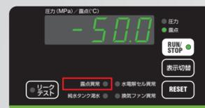
G2: 露点センサにより表示パネルで水素の露点温度を確認可能
