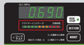
G1: 吸着剤の交換時期を表示パネルのインジケータで確認可能
