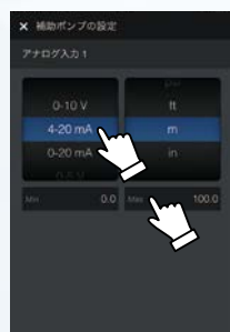
6 センサ仕様に応じて、測定単位を選択し、最小および最大センサ範囲値を設定します。
