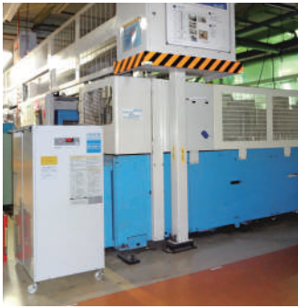
CNC 旋盤に搭載の浸漬型チラー更新例
