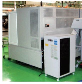
CNC 旋盤にオプション配管にて取付例
