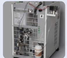
循環水の純度管理が可能。(写真はバイパス回路併設)
