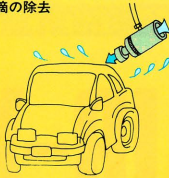
塗装作業における水洗後の水滴の除去
