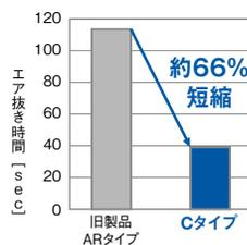
試験条件 [吐出圧力:1.0MPa, エア量:0.5mℓ]
