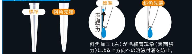
斜角加工(右)が毛細管現象(表面張力)による上方向への溶液付着を防止。
