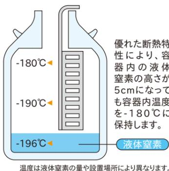
優れた断熱特性により、容器内の液体窒素の高さが5cmになっても容器内温度を-180℃に保持します。
