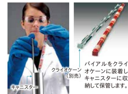
バイオケーンをクライオケーンに装着しキャニスターに収納して保管します。
