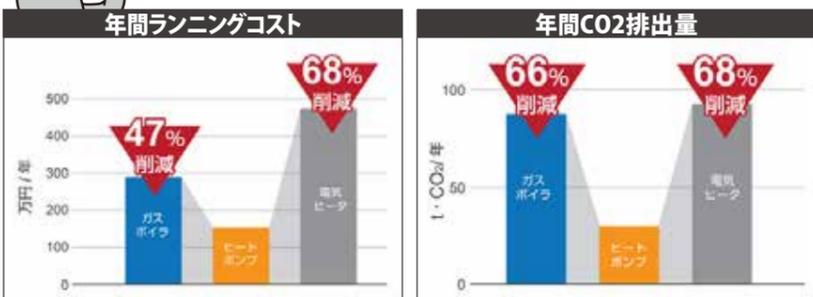
※ 温水入口温度60℃、出口温度65℃、年間を通じて24.2kWの熱源をガスボイラーもしくは電気ヒーターからヒートポンプに置き換えた場合のランニングコストとCO<sub>2</sub>削減効果を算出。電力単価:23円/kWh、ヒートポンプCOP:3.1、LPG単価:98.8円/kg、ボイラーシステム効率:50%、稼働時間:24時間×360日、CO<sub>2</sub>排出係数(電力):0.45kg・CO<sub>2</sub>/kWh、CO<sub>2</sub>排出係数(LPG):0.059kg・CO<sub>2</sub>/MJ
