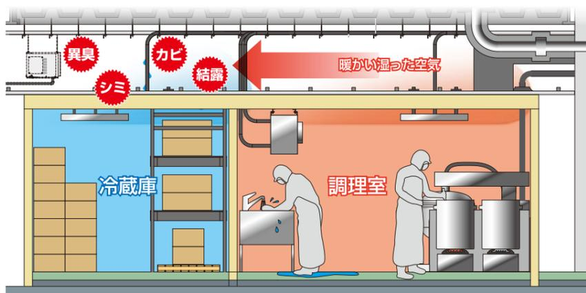
調理室と冷蔵室が天井裏でつながっている場合、暖かい湿った空気が冷蔵室側の冷えた天井部や吊金物、電気配線などに触れると結露が発生しやすくなります。天井裏で発生する結露は、そのままにしておくとカビ・シミなどの原因になります。天井裏の湿気対策、結露対策に天吊型除湿機をご提案します。
