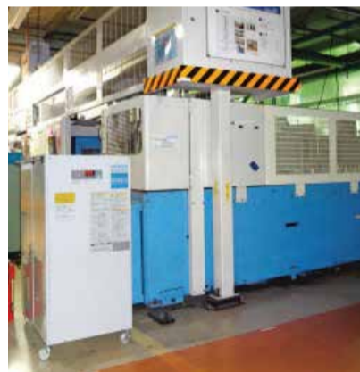
CNC旋盤に搭載例(浸漬型チラー)
