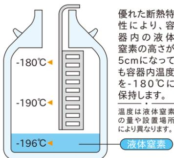
優れた断熱特性により、容器内の液体窒素の高さが5cmになっても容器内温度を-180℃に保持します。
